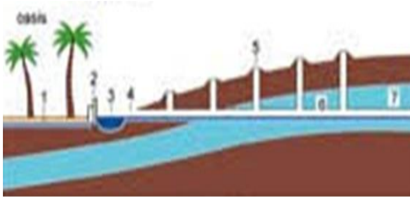
Figure 19 : Fonctionnement de la foggara
